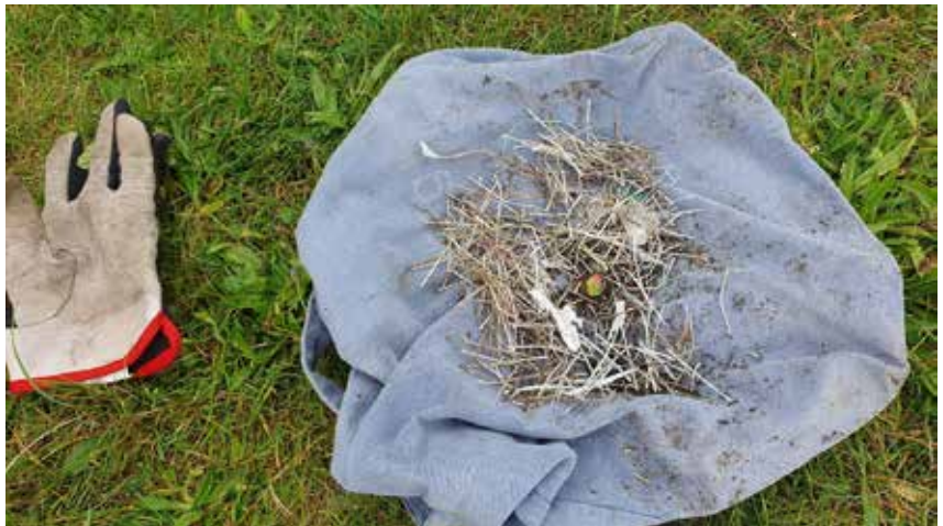
Armeringsfiber fra Ryfast er ca 1 mm tykk, 2-3 mm bred, 5-6 cm lang. Rogfast har fått forbud mot å bruke plastarmering. Foto: Rune Folkvord
